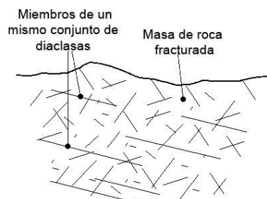
Figura 18. Esquema de una roca fracturada
