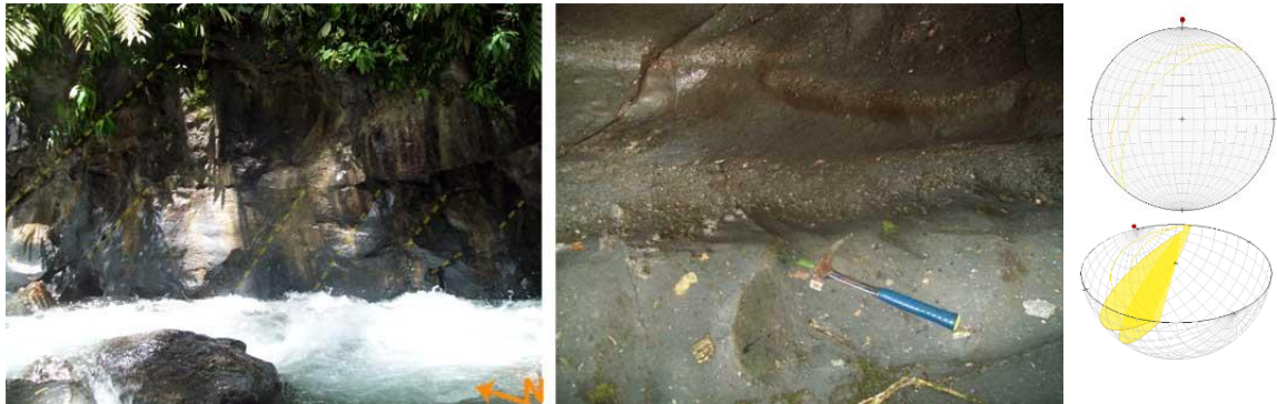
Figura 28. Planos cortando los depósitos volcánicos de la quebrada La Concha
