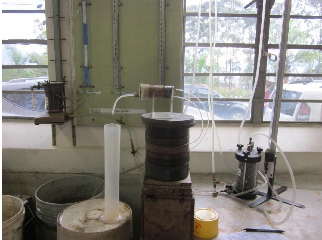
Fotografía 4-10: Ejecución del ensayo pinhole test .
