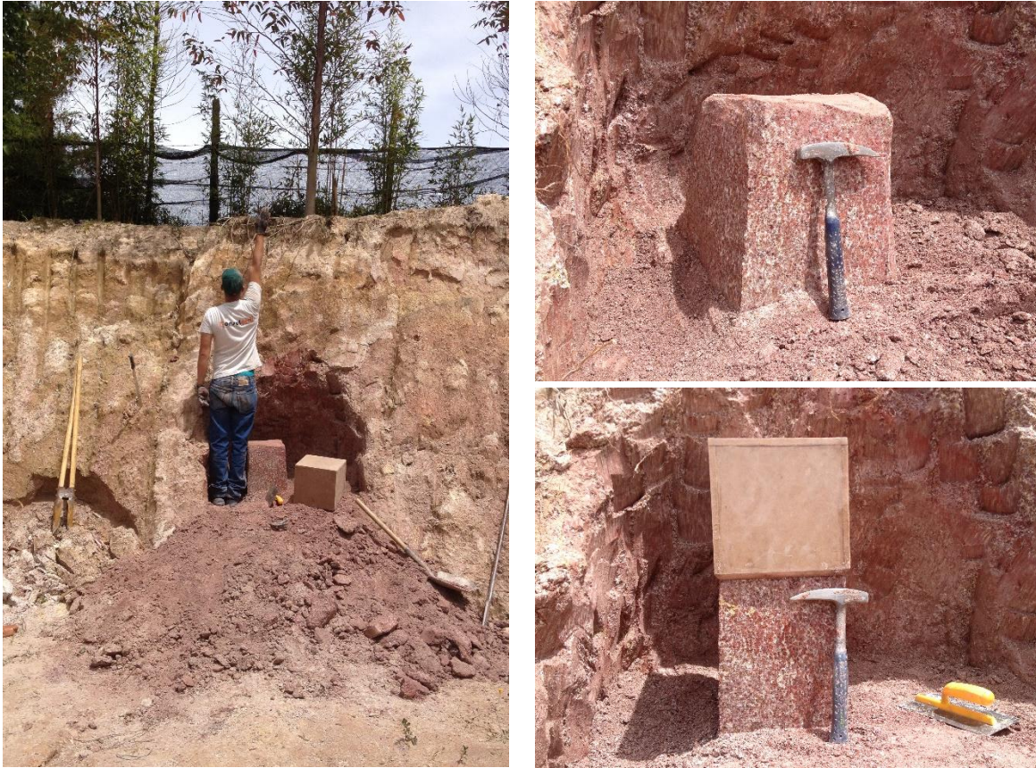
Fotografía 4-1: Secuencia de extracción de la muestra natural inalterada.
