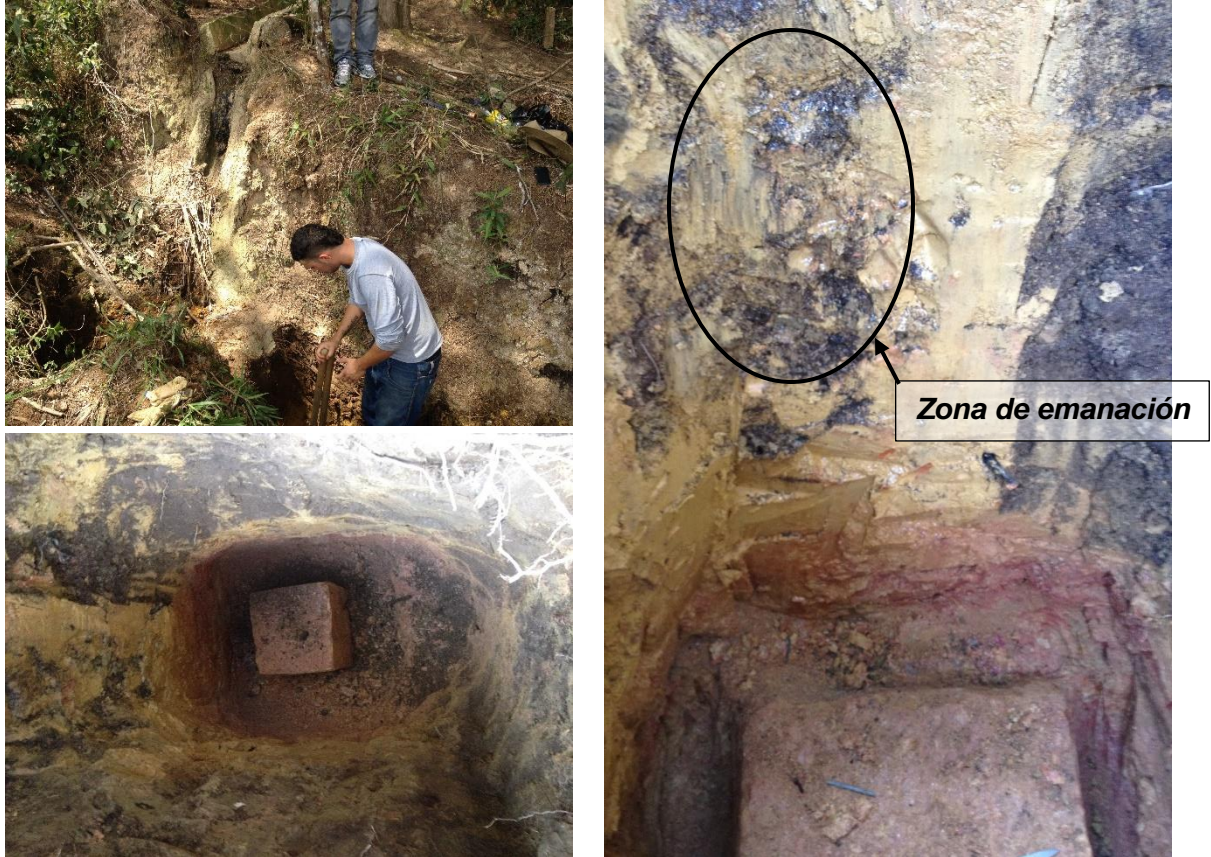
Fotografía 4-2: Secuencia de extracción de la muestra contaminada inalterada.
