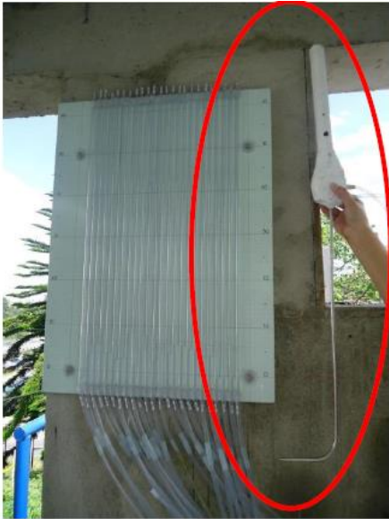
Figura 61. Sistema para medición de velocidades en el flujo a superficie libre. Tomado de (Informe Final modelo hidráulico Descarga de Fondo Proyecto estudiado)
