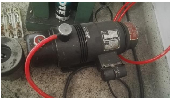
Fotografía 3. Bomba de vacío
