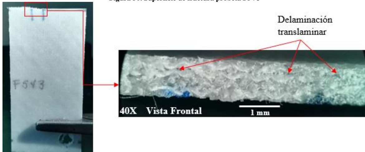
Figura 50. Superficie de fractura probeta F5V3
