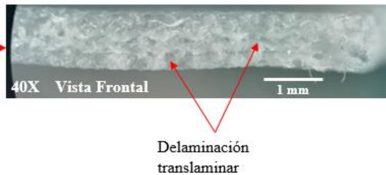
Figura 39. Superficie de fractura probeta T20V3
