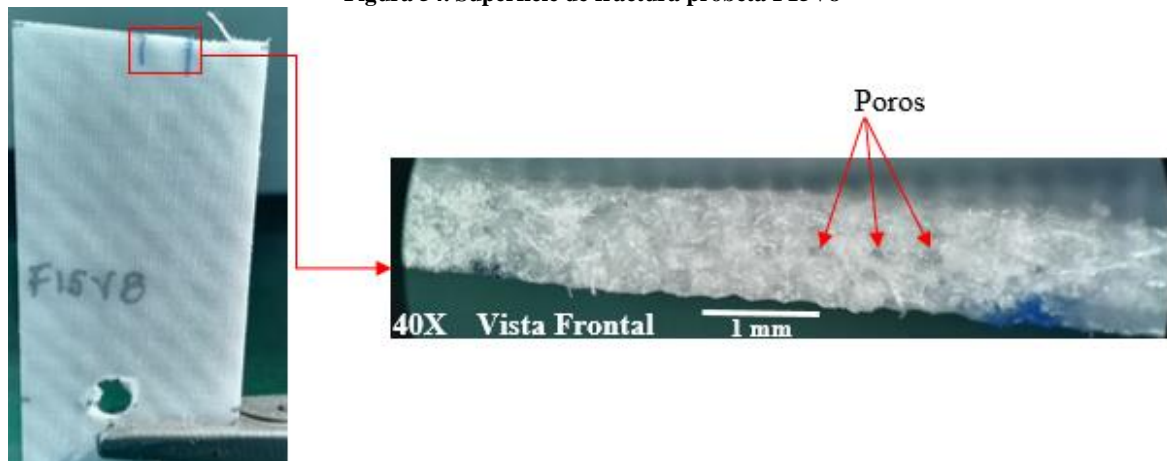
Figura 54. Superficie de fractura probeta F15V8
