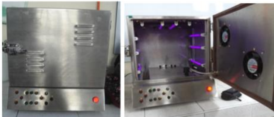
Figura 3. Montaje experimental usado en el proceso fotocatalítico. (Varela Reyes, 2013)
