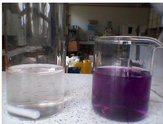
Figura 16. Comparación entre solución residual inicial diluida (derecha) y solución residual tratada con ilmenita (Izquierda).
