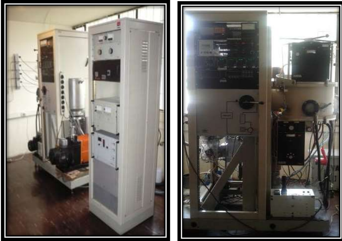
Figura 4.2. Equipo CIT-Alcatel HS 2000 para producción de películas delgadas mediante la técnica de sputtering magnetrón RF
