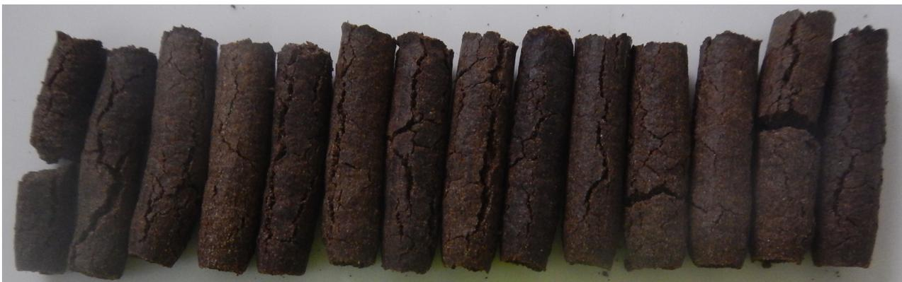
**Figura 5-5.** Pellets realizados con un tamaño de grano de 0,5 a 0,25 mm y una humedad de 20,12 %.
