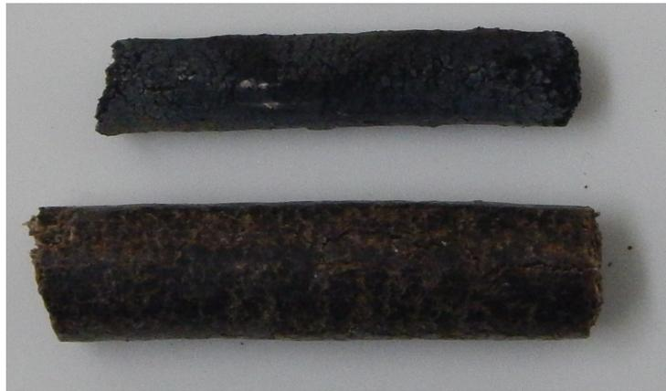
**Figura 5-16.** Comparación de pellets antes y después del proceso de pirólisis.
