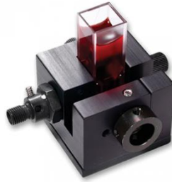
Figura 2-7: Portacubetas y celda adquiridos, marca Ocean Optics.
