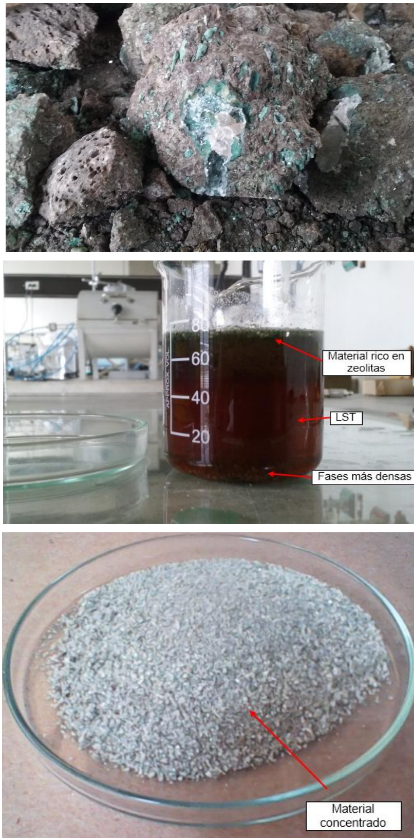
Figura 2-27: Registro fotográfico del proceso de concentración realizado
