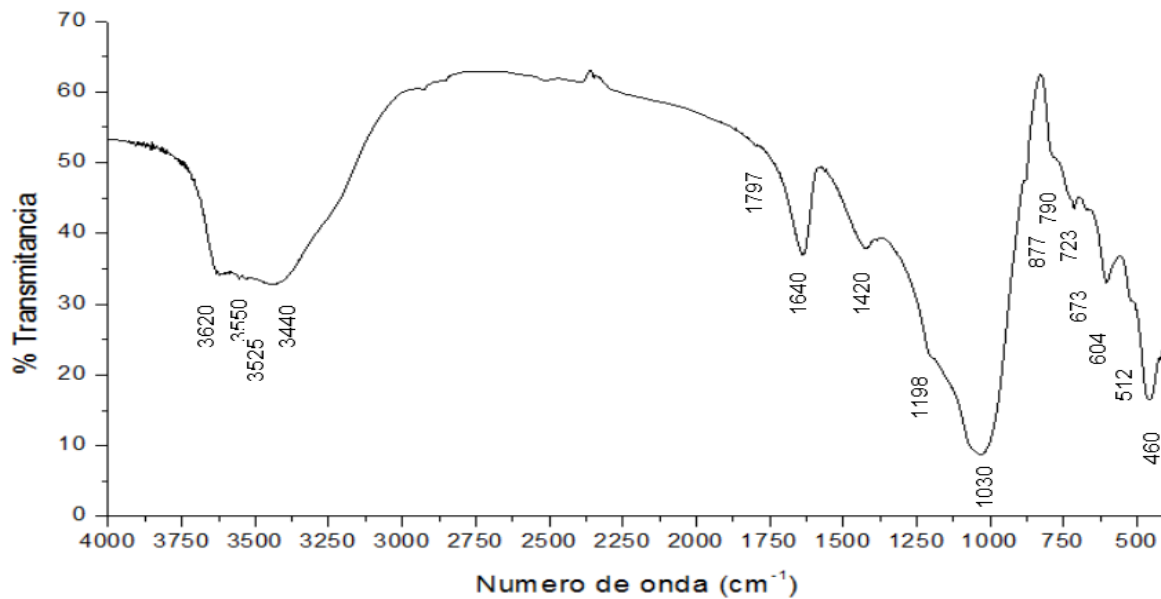
Figura 2-29: Espectro FTIR del material concentrado (Natzeo)
