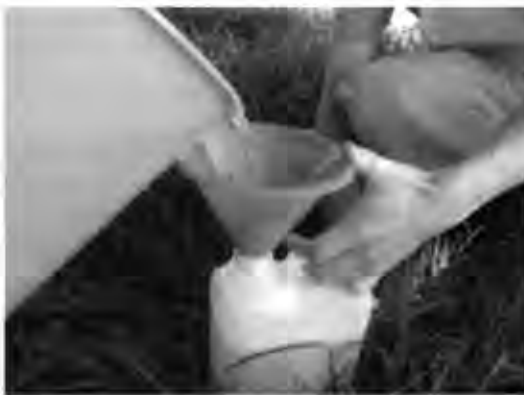
Fotografía 9. Recolección de muestra integrada de agua en recipiente para preservación y transporte al laboratorio.
