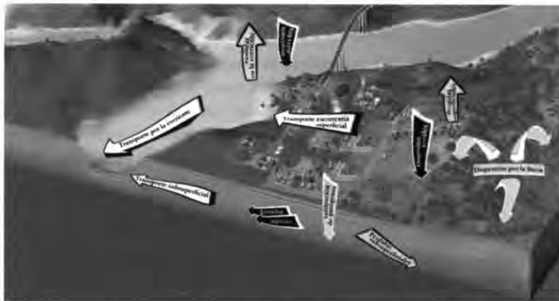
Figura 7. Acumulación de organismos patógenos y procesos de transporte a nivel de cuenca. El área de modelación que considera el modelo para el transporte y decaimiento de organismos propuesto corresponde a los procesos e interacciones únicamente dentro de la corriente.
