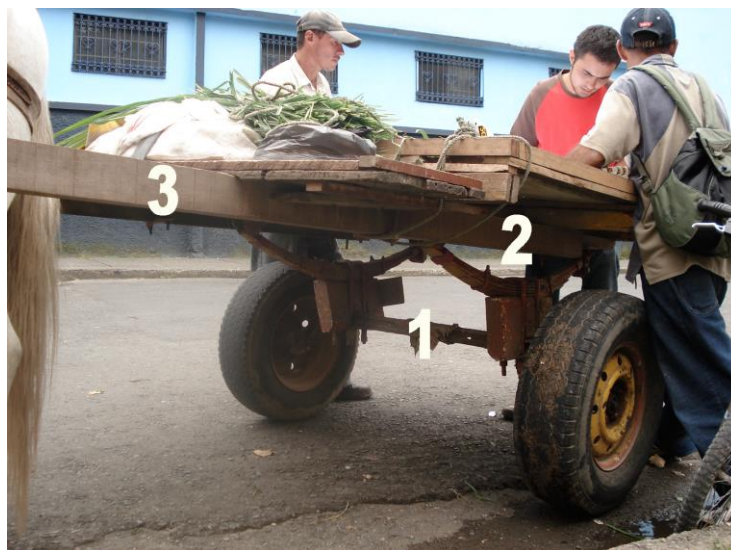
Figura 53 STE caso de estudio. 1. Eje de rodamiento. 2. Chasis. 3. Tiro.
