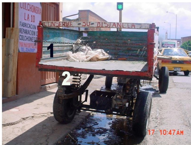
Figura 55 Carreta de un STE de Pereira. 1. Carrocería, estacas. 2. Sistema de suspensión, resortes y hojas de resorte.
