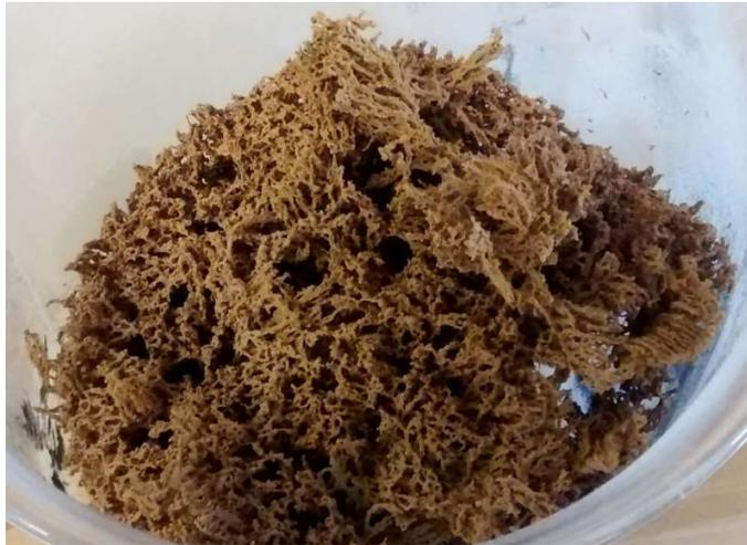
Luego de la obtención de polvos, se procedió a homogenizar en un mortero cerámico, obteniendo polvos de textura muy fina. En la figura 3-5 se muestran los polvos sintetizados, de los cuales se evidencia el cambio de coloración, siendo esto evidencia cualitativa de la sustitución catiónica de iones cromóforos.
