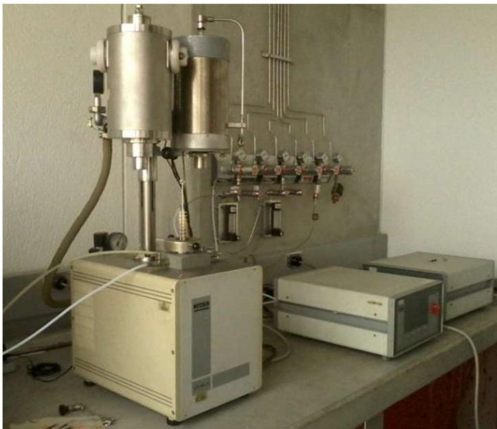
Además de evaluar los cambios calorimétricos, se evaluaron las variaciones de masa de los compuestos en función de la temperatura a partir de un análisis termogravimétrico (TG) empleando un Analizador Termogravimétrico (TGA) modelo 1600DTA Instruments, considerando un barrido de temperatura desde 29° C hasta 950 °C. Las mediciones termogravimétricas se realizaron en la Universidad de Antioquia, con el Grupo de investigación en Catalizadores y Absorbentes.
