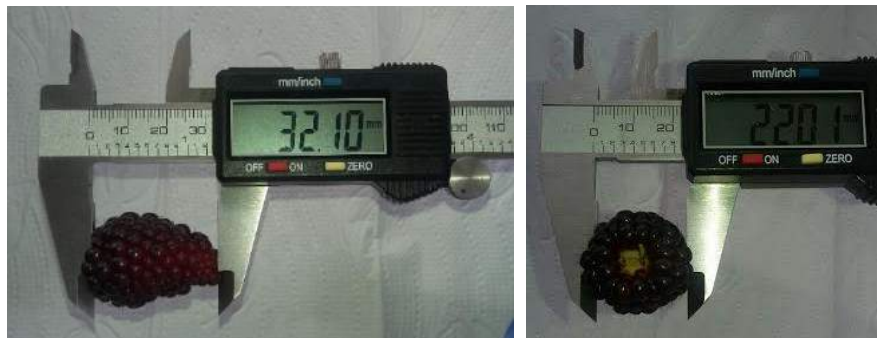
Figura 158. Medición del diámetro polar (izquierda) y diámetro ecuatorial (derecha).
