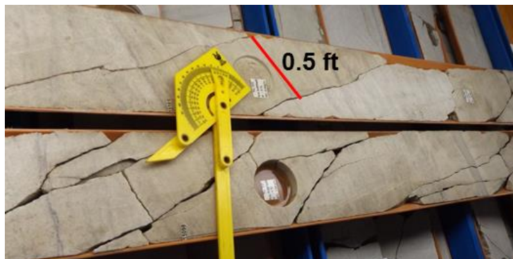
Figura 6-2. Sector anidado de fracturas de cizalla con espaciamiento < 1 ft, Pozo Pauto
