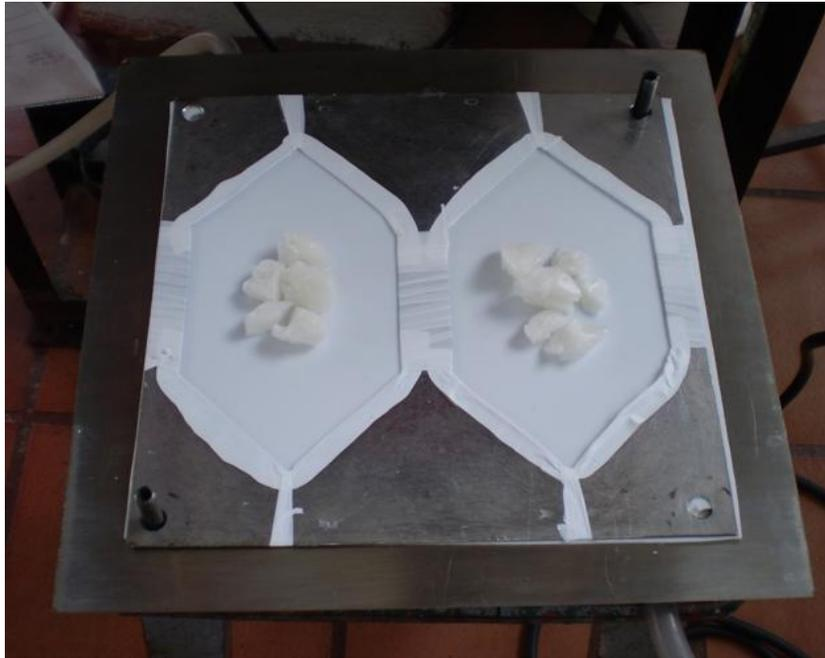
Figura 3-2. Equipo para producir las probetas por termocompresión
