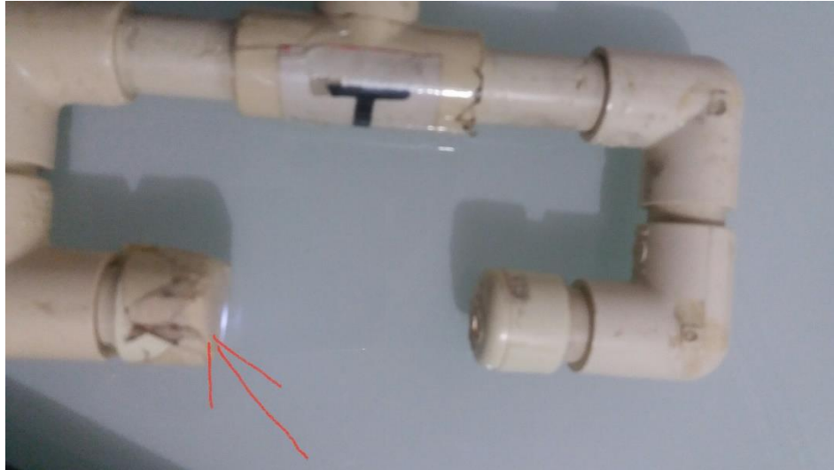
Figura 6. Fotocompuerta, en la fecha se aprecia la cinta de enmascarar (flecha roja) que disminuye la luz incidente en la fotorresistencia.
