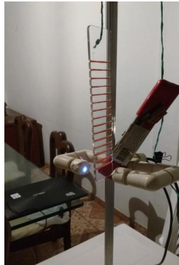
Figura 13. Montaje para la medición de la aceleración del campo gravitacional de la tierra. Imagen, archivo propio
