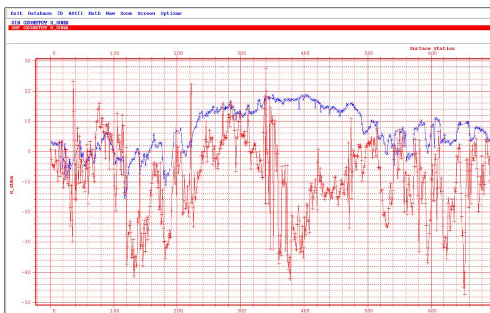
Figura 4-12.: Cálculo y aplicación de corrección estática por refracción de la onda PS, en el dominio de la fuente (azul) y en el dominio de receptor (rojo).
