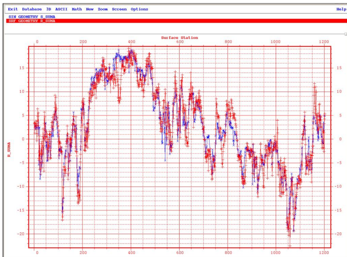
Figura 4-6.: Cálculo y aplicación de corrección estática por refracción de onda P, en el dominio de la fuente (azul) y en el dominio de receptor (rojo).
