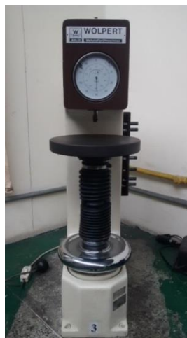
Figura 4.3. Durómetro ROCKWELL serie 574
