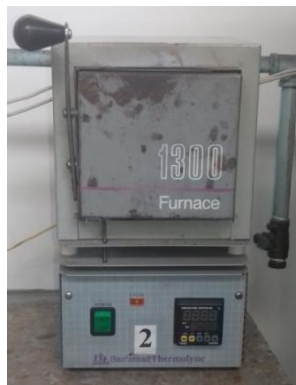
Figura 4.2 Horno empleado para realizar tratamientos térmicos
