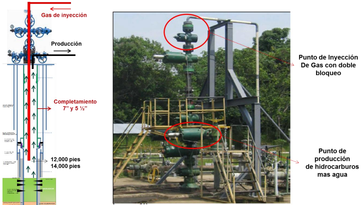
Figura 6 Esquemático de “gas lift coiled tubing” en superficie y en fondo de pozo (Fuente Equión Energía)
