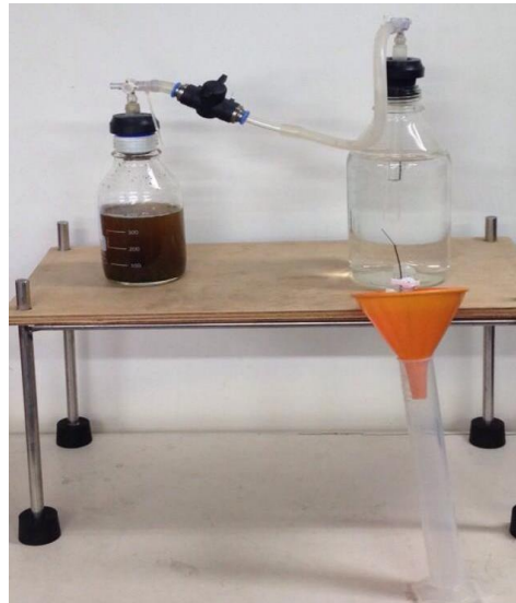
Figura 4-8. Medición de biogás por la técnica de desplazamiento de agua.
