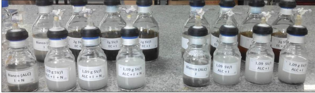
Figura 4-11. Montaje de los reactores con ARL
