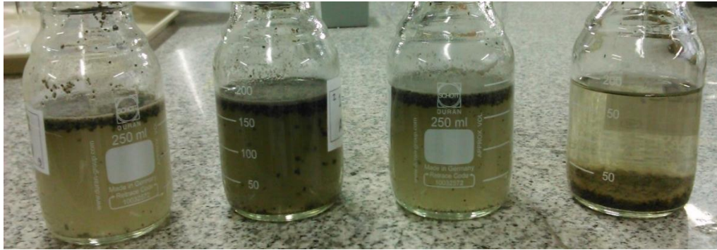
Figura 5-20. Reactores con ARL en los días con mayor producción de biogás, blanco en el extremo derecho.
