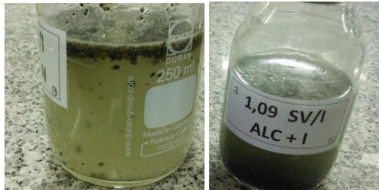
Figura 5-21. Inóculo ubicado en la parte superior (a) y capa grasosa en la superficie (b) en reactor con ARL
