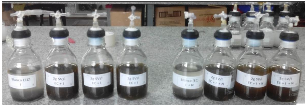
Figura 4-10. Montaje de los reactores con EC
