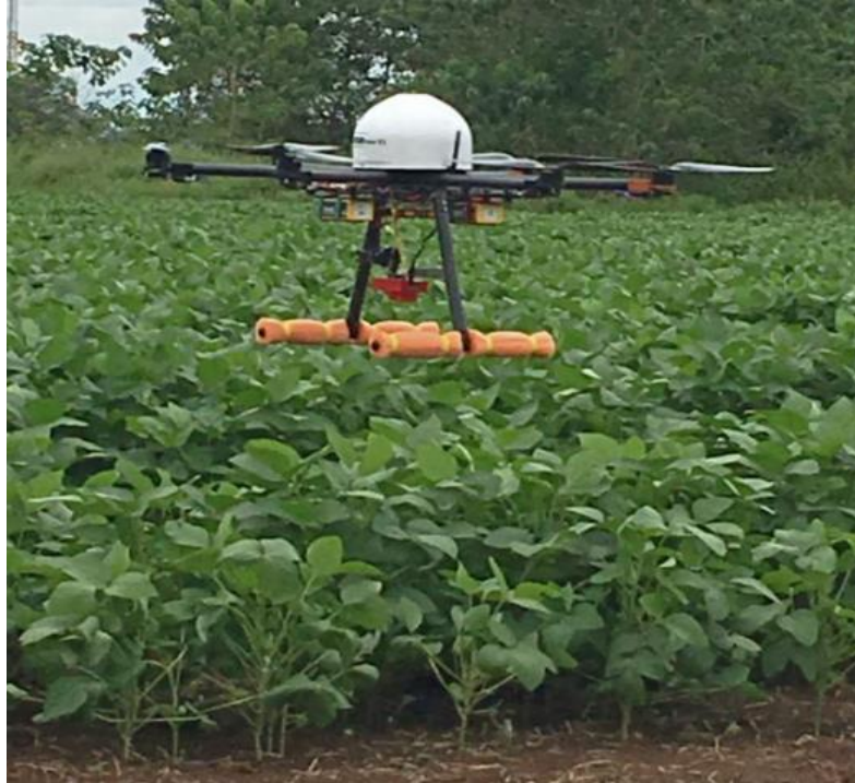
Figura 3-4: RPAS equipado con el sensor multiespectral, baterías y gps, sobrevolando el cultivo de soya
