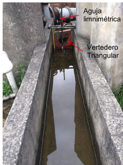
Figura 3-18: Canal rectangular, vertedero triangular y aguja limnimétrica.
