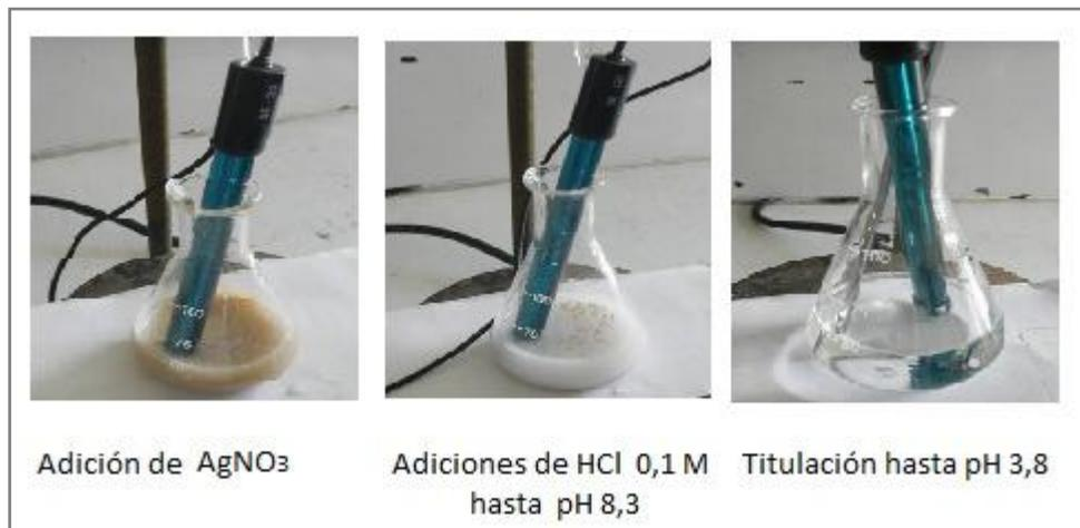
**Figura 41.** Esquema del proceso de análisis de  $\text{CO}_2$
