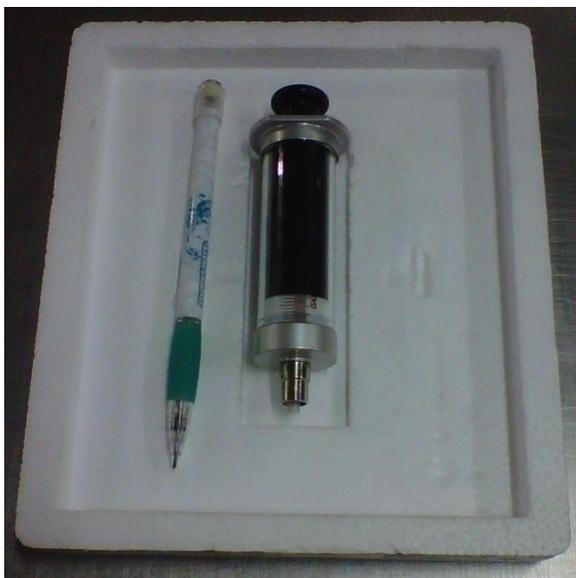
**Figura 21.** Jeringa empleada para la determinación del volumen interno de la estructura metálica.
