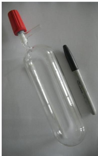
**Figura 15.** Fotografía de la botellas Giggenbach empleada para el muestreo de gases volcánicas.
