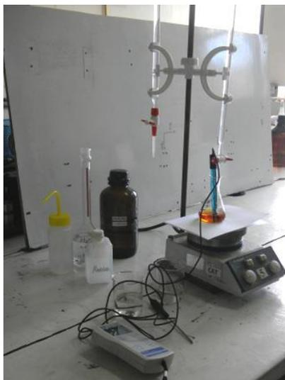
**Figura 42.** Montaje utilizado en la determinación de  $\text{H}_2\text{S}$
