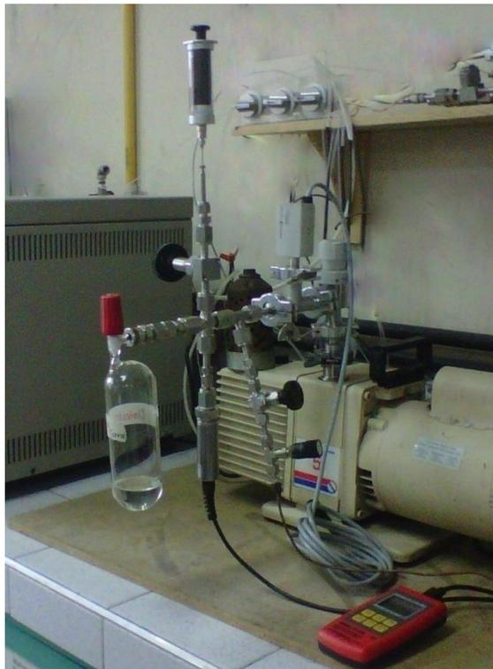
**Figura 22.** Montaje completo para la determinación del volumen interno de la estructura metálica.
