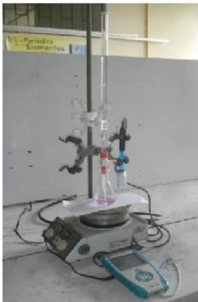
**Figura 40.** Montaje utilizado en la determinación del contenido de CO<sub>2</sub>.
