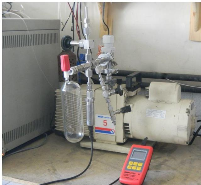
**Figura 19.** Fotografía de la estructura metálica desarrollada para la extracción de las muestras gaseosas en las botellas Giggenbach.
