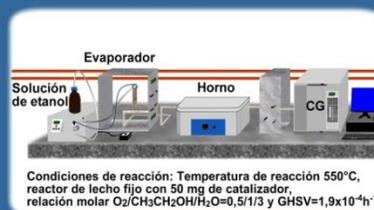
Condiciones de reacción: Temperatura de reacción 550°C, reactor de lecho fijo con 50 mg de catalizador, relación molar  $O_2/CH_3CH_2OH/H_2O=0,5/1/3$  y  $GHSV=1,9 \times 10^{-4} h^{-1}$
