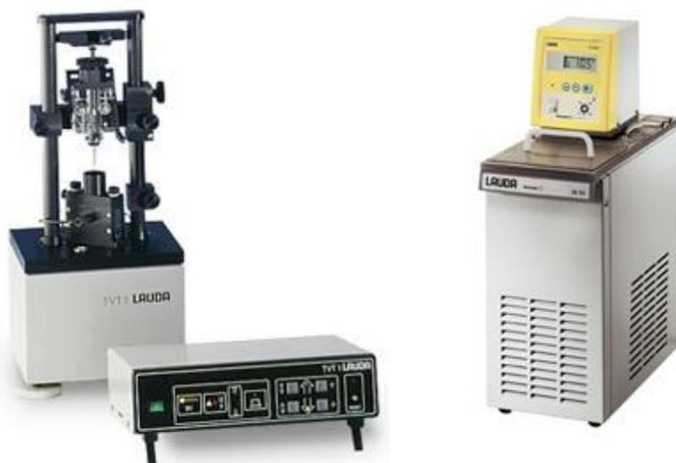
Figura 18. Tensiómetro Lauda TVT2 y termostato Lauda E100. Ref. [88].
