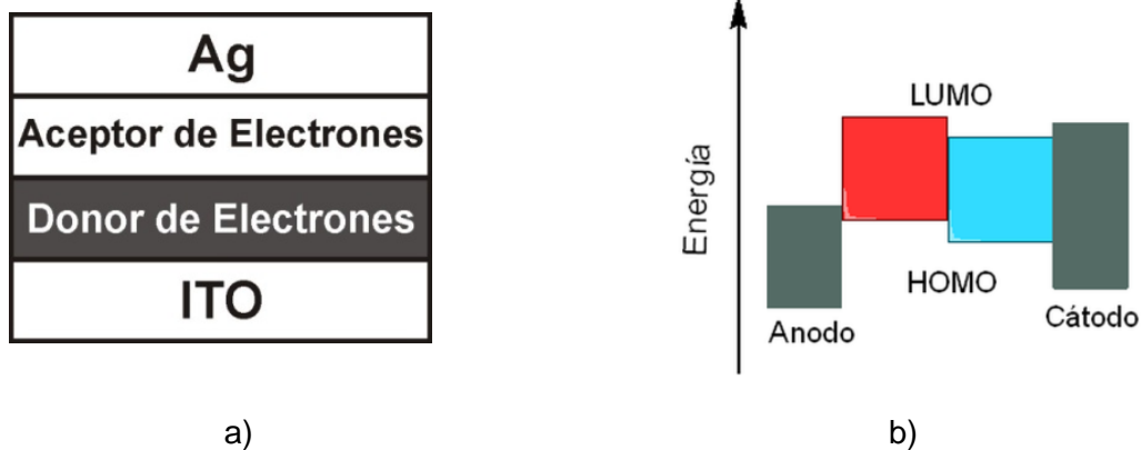
Figura 1.4. Celda solar con heterojuntura. a) Esquema de la celda. b) Disposición de las bandas de energía
