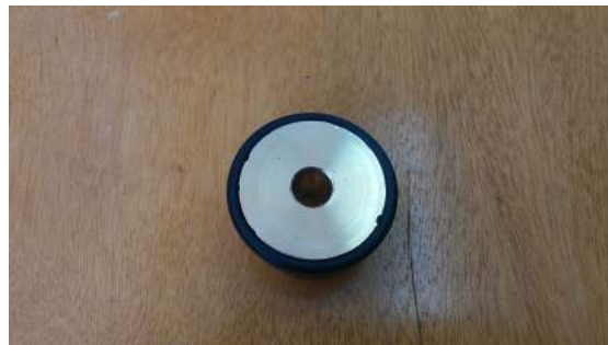
Figura 4-23.: Generador de Humo - Acople Generador de Humo con implementación de O-Ring .
