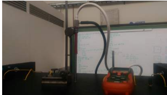
Figura 5-4.: Configuración Experimental - Soporte 1 Montaje Experimental Tubo Pitot-Estático
