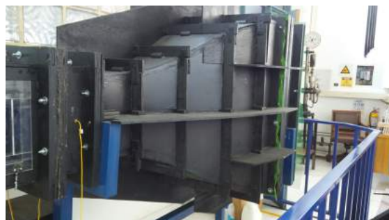
Figura N-6.: Fotografías - Zona de Contracción
