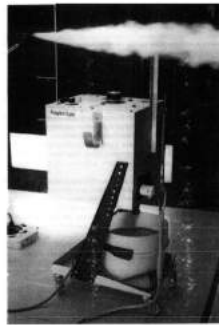
Figura 5-2.: Marco Teórico - Generador de HUmo con Vara de liberacion usando en el Tunel de Viento Glenn L. Martin [11].
