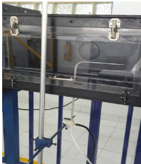
Figura 5-5.: Configuración Experimental - Soporte 2 Montaje Experimental Tubo Pitot-Estático
