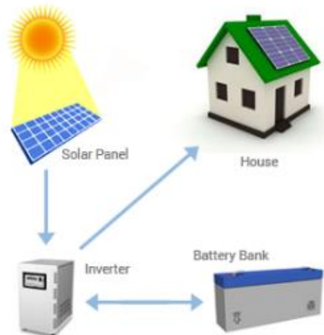
Figura 6. Sistema solar aislado o autónomo
