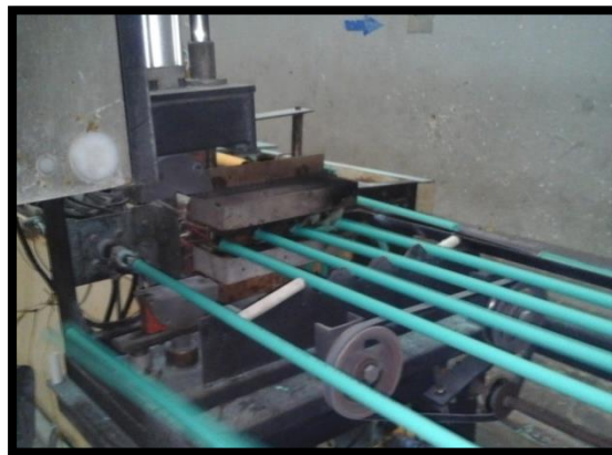
Figura 2-13. Acampanador línea 1 de extrusión Empresa Tuboplex.
