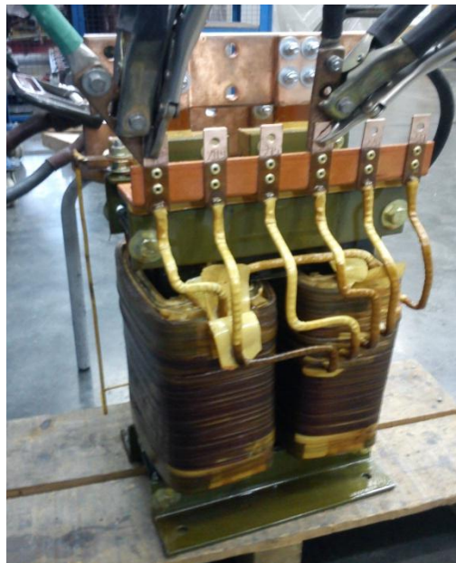
Figura 14: Transformador de potencia monofásico 10 KVA
