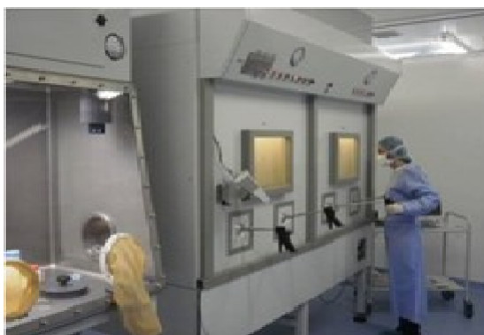
Figura 2-3: Cabina y área dedicada a la manipulación de ^{131}\text{I}
