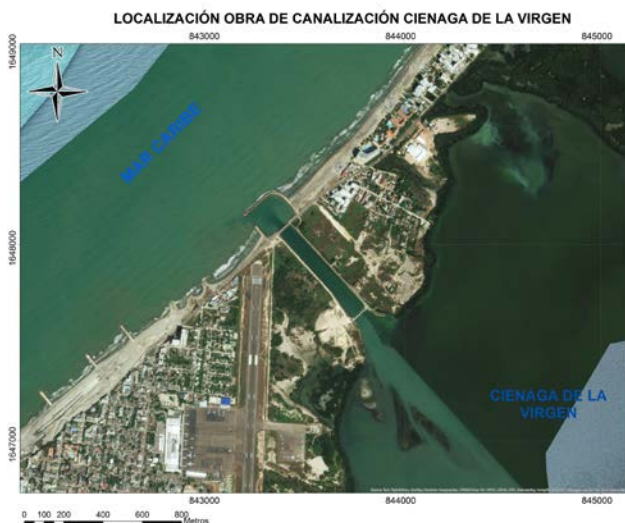
Figura 7. Canal de salida de agua de la Ciénaga de la Virgen con un Guía Corriente en la desembocadura atrapando los sedimentos. Fuente: Adaptado de ArcGis Mapeo Base 2015.
