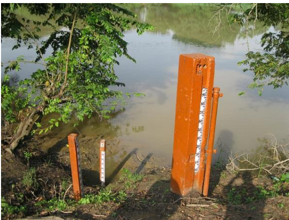
Fotografía 1-1 Regletas sobre la estación La Doctrina
