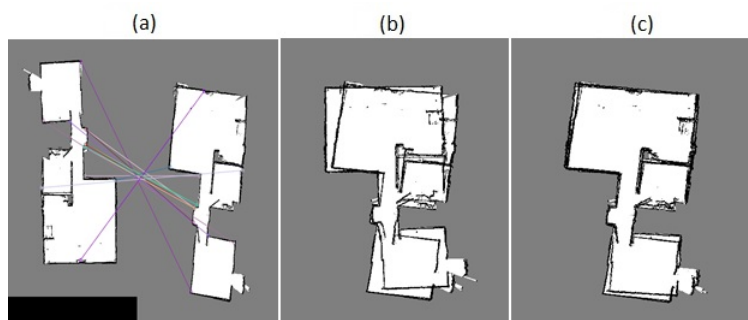
Figura 4-4.: Cálculo de transformación rígida usando RANSAC (a) y el resultado de su mezcla (b), y el resultado obtenido por la etapa de refinamiento (c). En la figura a se observa como sobre un punto se cruzan todas las parejas correspondientes inliers.
