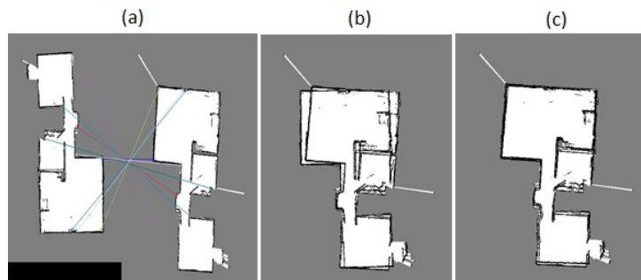
Figura 4-4.: Cálculo de transformación rígida usando RANSAC (a) y el resultado de su mezcla (b), y el resultado obtenido por la etapa de refinamiento (c). En la figura a se observa como sobre un punto se cruzan todas las parejas correspondientes inliers.
