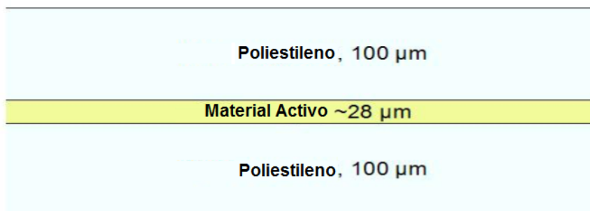
Figura 3-5.: Esquema de capas de películas radiocrómicas EBT3. Imágen tomada de la referencia [1], página 10.
