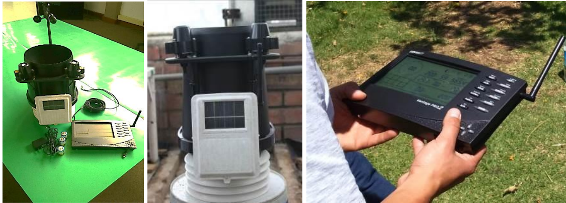
Figura 16. Estación meteorológica marca DAVIS “Vintage Pro 2” empleada para el registro de variables climáticas (Fotos: Autor).
