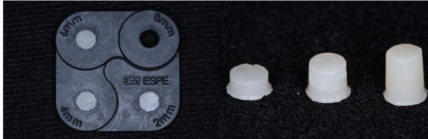
Fig 6 a) Discos de resina de diferentes espesores dentro del conformador. b) discos de resina de diferentes espesores 2mm, 4mm, 6mm.
