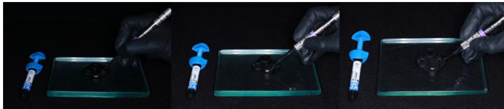
Fig.4 se observa la realización de los discos de resina con el conformador a plástico a diferentes espesores a) 2mm b) 4mm y c) 6mm
