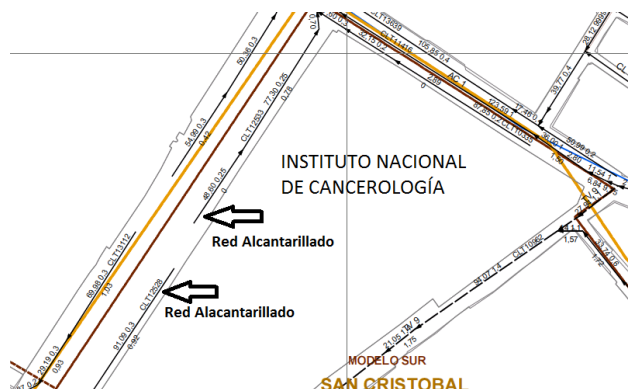
Figura 5.9: INC -Red de Alcantarillado (b)
