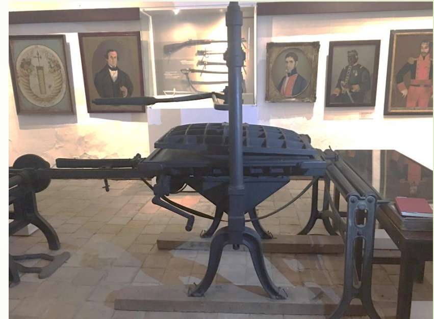
Título: Washington Iron Hand Press de R. HOE & CO. (New York & London). Objeto: Prensa de la Convención de Rionegro (1863). Periodo: siglo XIX. Dimensiones: 1,81 * 1,50 * 2,34 m
