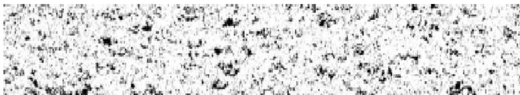
**Figura 5-43:** Imagen obtenida del simulador para una porosidad real de 14.39 % depositada por APS, muestras obtenidas del GTS[96]
