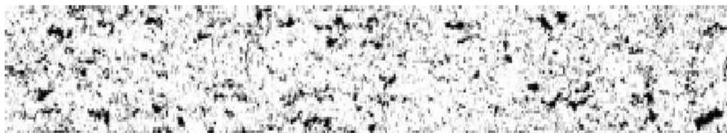
**Figura 5-44:** Imagen obtenida del simulador para una porosidad real de 15.83 % depositada por APS, muestras obtenidas del GTS[96]
