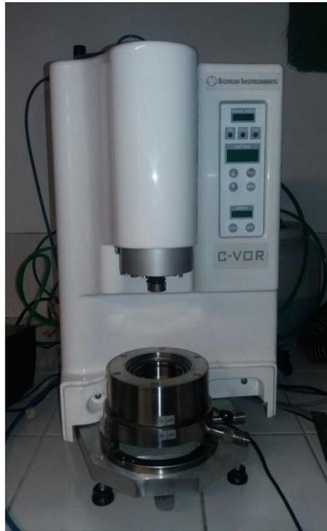
**Figura 12.** Reómetro utilizado en la medición de la viscosidad de las suspensiones
