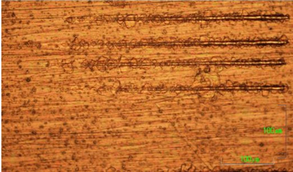
**Figura 55.** Huella del ensayo de indentación sobre recubrimiento tipo I. magnificación x 20X
