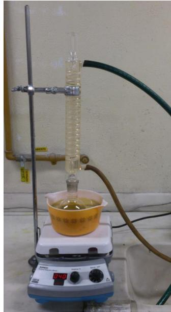
**Figura 11.** Montaje realizado para la obtención del sol de Sílice
