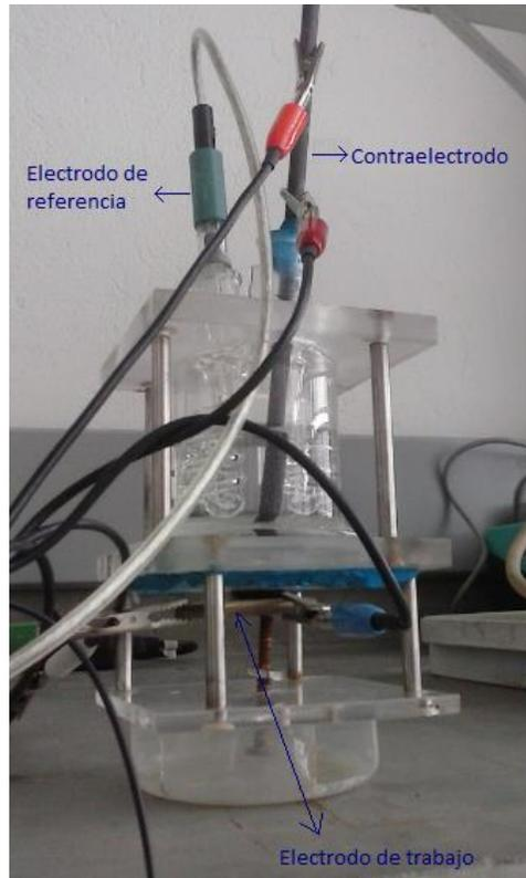
**Figura 22** Celda electroquímica usada para el ensayo de polarización cíclica potenciostato/galvanostato/ZRA GAMRY 600
