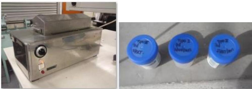
**Figura 19.** Montaje realizado para la inmersión en SBF de las probetas recubiertas
