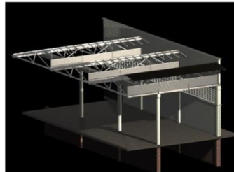
Pórticos de ferro-concreto. Muros de cerramiento en material, en mamposterías simples de ladrillo macizo tipo Tablazo pega sogá.
