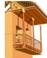
Los cerramientos, puertas y ventanas, en madera.
