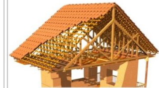
Cielorrasos Estructuras en cerchas de madera y guadua con grandes aleros y con cubiertas en teja de barro
