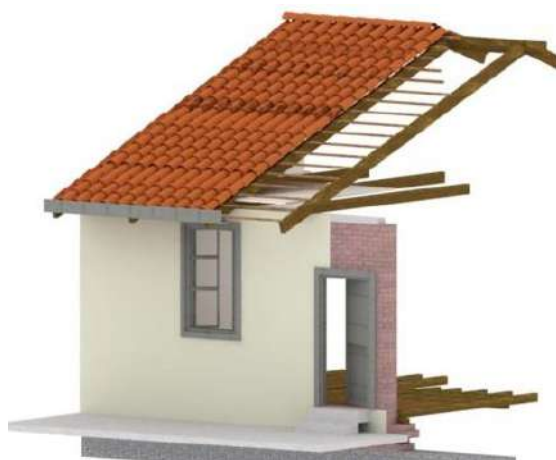
Imagen 45: sistema constructivo casa de material de transición. Barrio Chipre Nuevo
