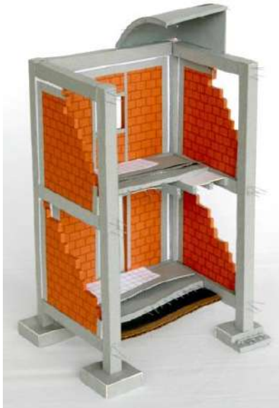
Imagen 68: sistema constructivo pórticos de concreto reforzado posmoderno, de baja altura
