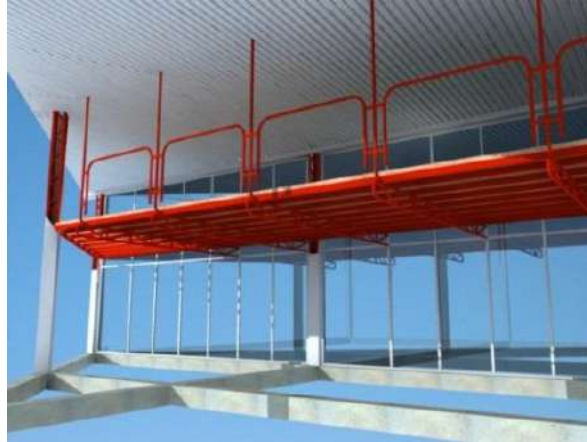
Imagen 79: sistema constructivo pórticos metálicos en celosías posmoderno. MERCALDAS
