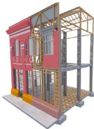
Imagen 34: subsistema constructivo pórticos de cemento armado y bahareque encementado
