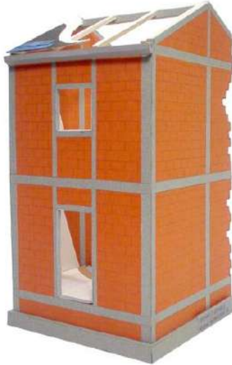
Imagen 69: sistema constructivo mampostería confinada posmoderno, de baja altura
