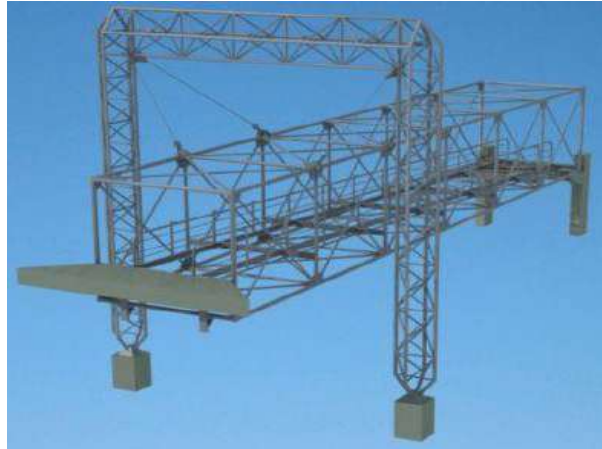
Imagen 80: sistema constructivo pórticos metálicos tubulares tridimensionales posmoderno. Puente peatonal Centro Comercial Parque Caldas
