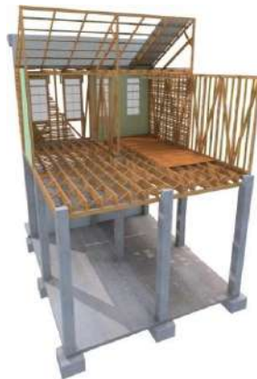
Imagen 31: subsistema constructivo bahareque encementado sobre columnas de cemento armado
