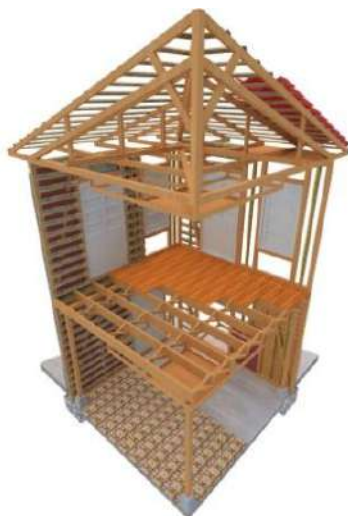
Imagen 26: sistema constructivo bahareque de tierra sobre columnas de madera
