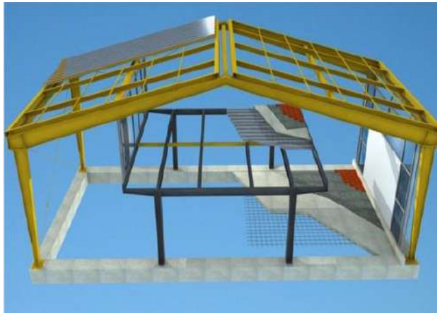
Imagen 63: sistema constructivo pórticos metálicos de alma llena, moderno tardío Depósito – Bloque X
