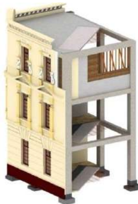
Imagen 37: subsistema constructivo pórticos de cemento armado, mampostería y bahareque encementado
