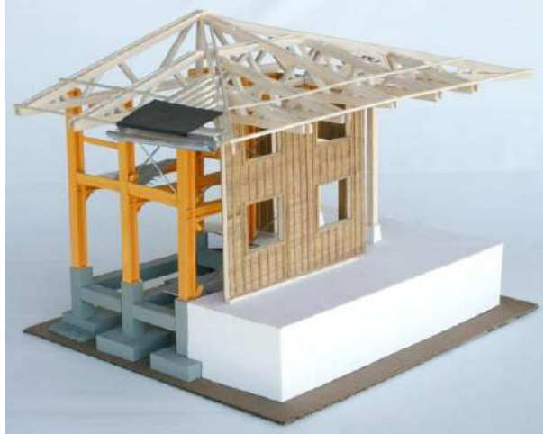
Imagen 81: sistema constructivo pórticos metálicos de alma llena posmoderno Edificio El Cable – BICN
