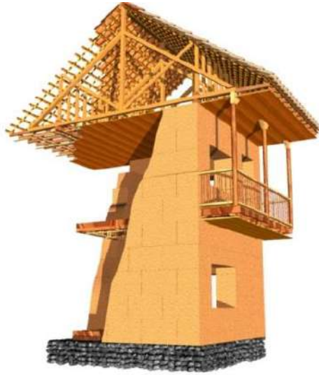
Imagen 6: sistema constructivo tapias de tierra pisada
