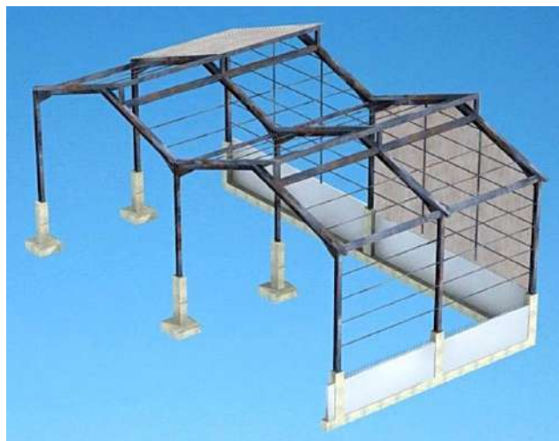
Imagen 57: Sistema constructivo pórticos metálicos alma llena moderno.
