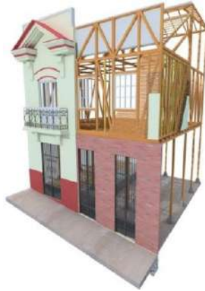
Imagen 30: subsistema constructivo bahareque encementado y mampostería sobre columnas de madera
