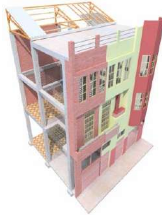
Imagen 35: subsistema constructivo pórticos de cemento armado y mampostería
