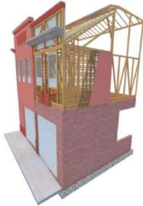
Imagen 29: subsistema constructivo bahareque encementado y mampostería
