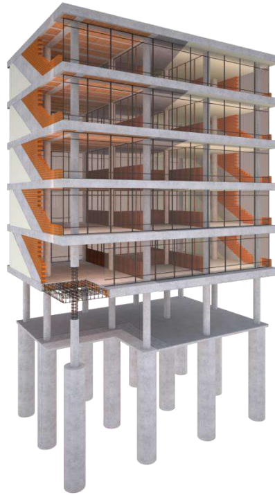
Imagen 50: sistema constructivo ferro concreto moderno, estructura DOM-INO. Antigua Alcaldía.
