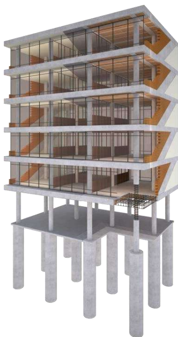
42: Sistema constructivo: Ferro Concreto (Moderno). Antigua Alcaldía – Demolido 2002.
