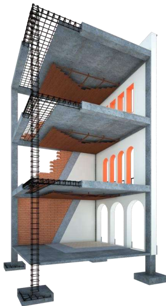
39: Sistema constructivo: Ferro Concreto (Transición). Primer Club Manizales (Manzana 121-902)
