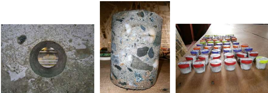
Muestra de perforaciones de terrazas, cilindros de concreto y partículas de análisis
