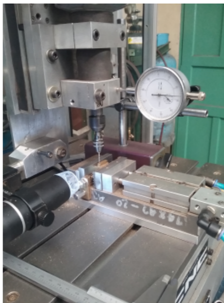
Figura 3.1: Sistema físico para la medición del error.
