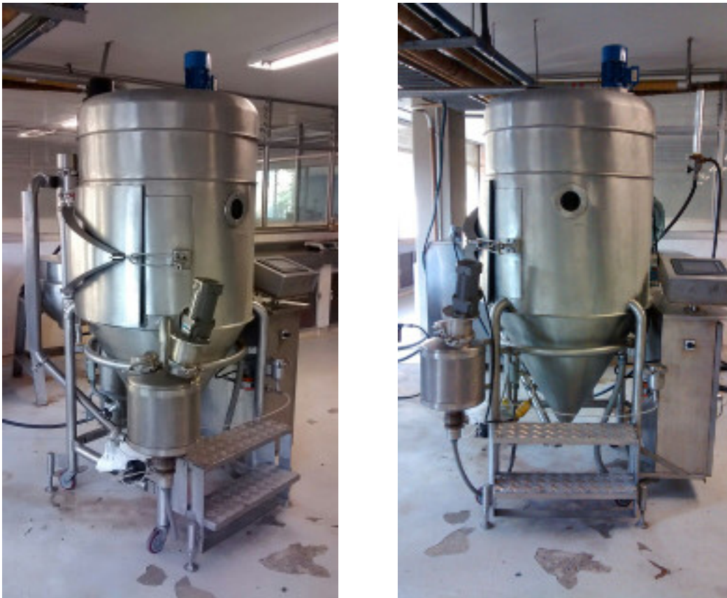
Figura 5-2.: Secador por aspersión con capacidad de evaporación de 10 kg/h de agua del laboratorio de operaciones unitarias de tecnología e ingeniería de alimentos de la Universidad del Valle, Cali - Colombia.
