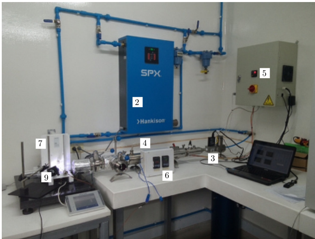
Figura 4-2.: Detalles del secador de gota construido: (2) secador de aire, (3) controlador de flujo másico, (4) calentador de aire, (6) transductores de temperatura, (7) micro balanza y (9) cámara de video.
