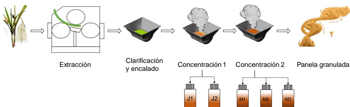
Figura 3-3 Proceso de producción de panela granulada y puntos de muestreo de ambos trapiches
