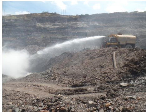
Figura 2-27. Enfriamiento de manto de carbón en Cerrejón, con la ayuda de un tanquero.
