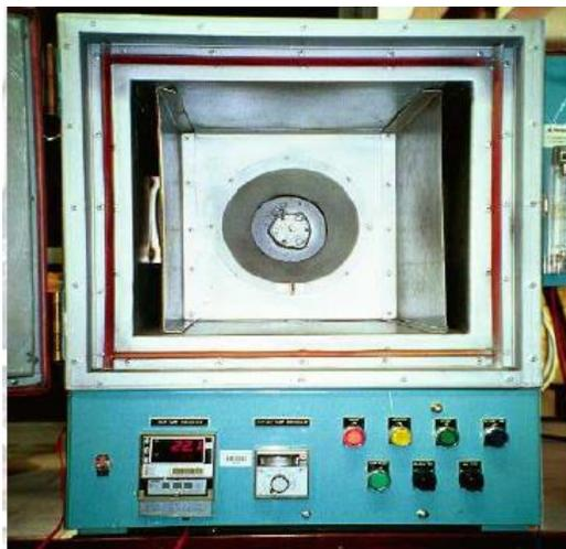
Se tiene que valores de  $R_{70}$  inferiores a  $0,5^{\circ}\text{C}/\text{hora}$  son para carbones poco propensos a la combustión espontánea, entre  $0,5-0,8^{\circ}\text{C}$  tienen una propensión media y con valores superiores a  $0,8^{\circ}\text{C}$  presentan alta propensión (B. B. Beamish, 2015; X. Qi et al., 2013). En la Figura 1-10 se muestra la curva de autocalentamiento adiabático  $R_{70}$  para un carbón bituminoso altamente volátil.
