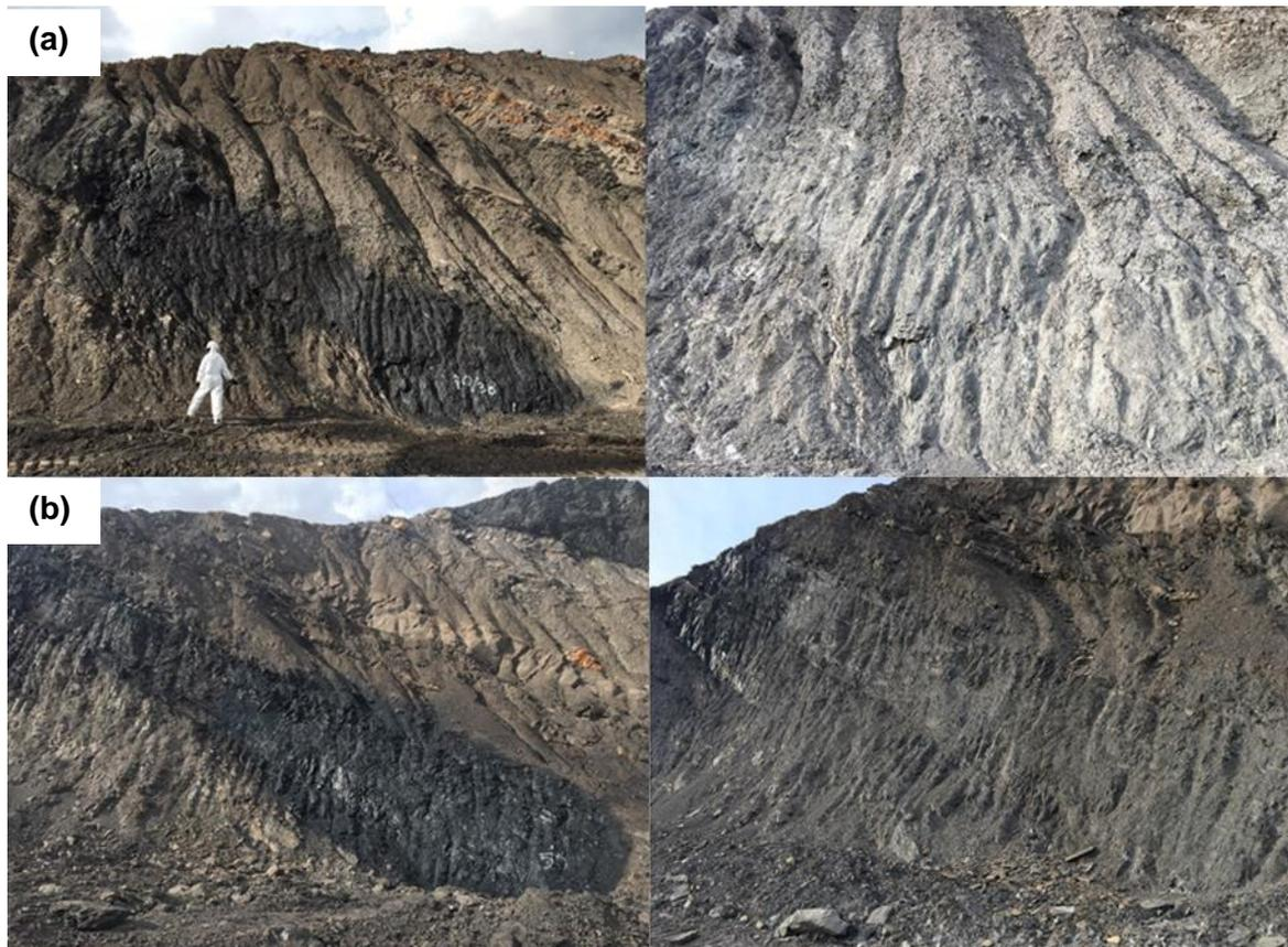
En la Figura 5-5a se presenta el sellamiento realizado con bitumen-salmuera en una relación 50/50 el día que se aplicó el producto y dos meses después de la aplicación, y en la Figura 5-5b se observa el sellamiento realizado con bitumen-agua en una relación 70/30 en los mismos instantes de tiempo.
