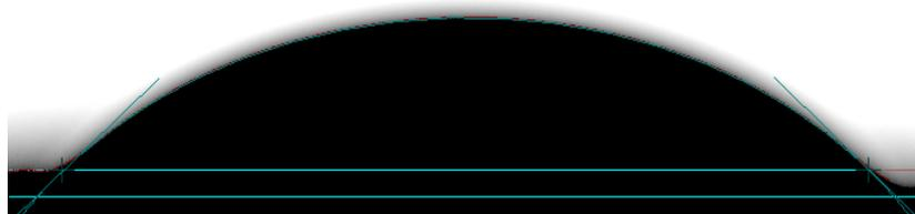
En la Tabla 5-1 se presenta el resumen de los resultados obtenidos de las mediciones de ángulos de contacto del bitumen sobre la superficie del carbón proveniente de Cerrejón.
